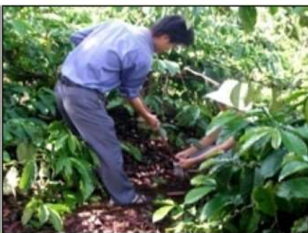
Hình 26. Dùng dụng cụ lấy mẫu đất (trước đó đã dùng cuốc đào lỗ)
