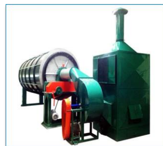
Hình 7.19. Máy sấy trống quay do Công ty cơ khí Xuân Hòa sản xuất
