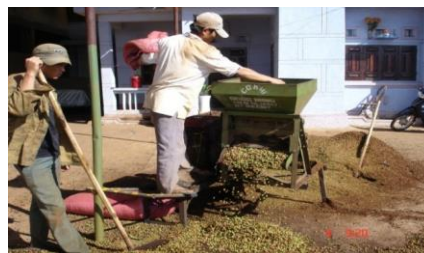
Hình 7.13. Chế biến theo kiểu xát đập
