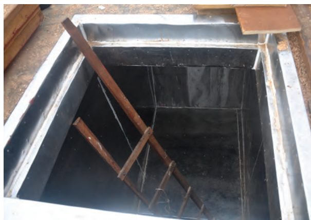
Hầm tàu sau khi được bọc inox 304
